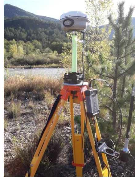
Figure 4: Matériel nécessaire pour le relevé GPS des points de contrôle
